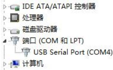
(3) 确认后，给驱动器通电，打开调机软件，文件下拉，串口设置，选择对应的串口号。然后打开串口。
