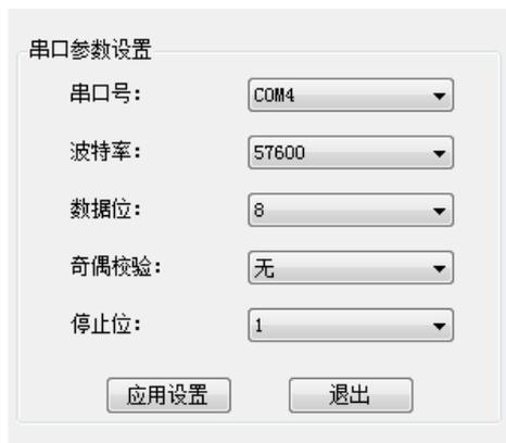
(4) 打开串口后，第一次软件会自动把驱动内部设置参数读入。若通讯失败，左下角会显示通讯故障，或读入参数失败。判断通讯是否成功，以是否读入到驱动版本为条件。若驱动版本为 UNKNOW，通讯失败，请检查硬件连接。
